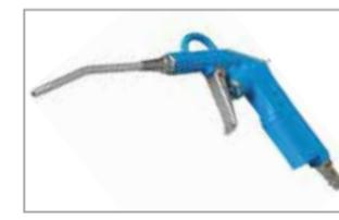
Zum Abblasen von Flüssigkeiten, Düsenrohrlänge ca. 11 cm. Gehäuse aus Aluminium-Druckguß, kompl. mit Anschlußsnippel montiert. Anschlußgewinde: 1/4" IG, Betriebsdruck: 1-10 bar, Luftverbrauch: 120-600 ltr./min.
