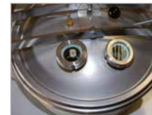
Zur Prozesskontrolle 2 Deckelschaugläser im Kesseldeckel, einer davon mit Wischersystem
