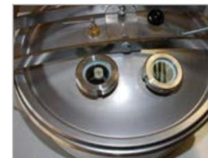
Zur Prozesskontrolle 2 Deckelschaugläser im Kesseldeckel, einer davon mit Wischersystem
