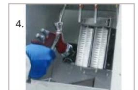
4. Zur Reinigung der Luftkappe befindet sich eine Reinigungsbürste im Pistolencenter. Die Lackreste und der Reiniger werden in einer Ausblasöffnung entsorgt und gesammelt.
