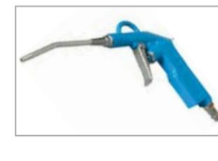
Zum Abblasen von Flüssigkeiten, Düsenrohrlänge ca. 11 cm. Gehäuse aus Aluminium-Druckguß, kompl. mit Anschlußsnippel montiert. Anschlußgewinde: 1/4" IG, Betriebsdruck: 1-10 bar, Luftverbrauch: 120-600 ltr./min.
